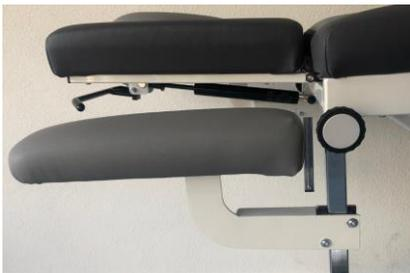
Der Kopfteil kann stufenlos verstellbar werden. Durch Anheben des Kopfteilhebels direkt unterhalb des Kopfteils hebt das Kopfteil automatisch an. Um das Kopfteil zu senken, heben Sie den Kopfteilhebel an und drücken Sie den Kopfteil gleichzeitig bis zur gewünschten Position nach unten. Die Fußteilverstellung und Dachstellung erfolgen genauso.
